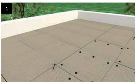
Les panneaux sont fixés au moyen de trois clous par poutre de support. Les clous doivent être placés à au moins 150 mm des bords longitudinaux.
