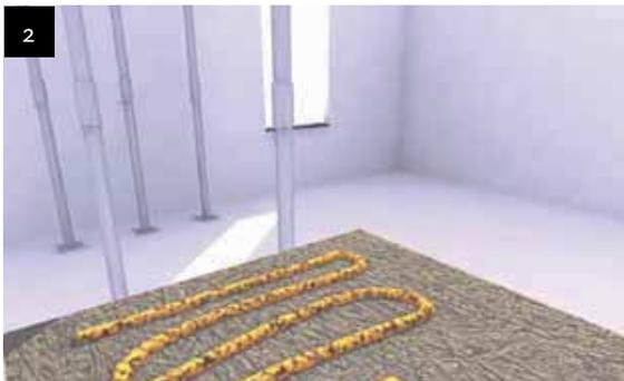
Le support plan doit être propre, dépoussiéré et dégraissé. Appliquer la colle d'un côté du panneau en rainures selon le mode d'emploi de Heracolte.
