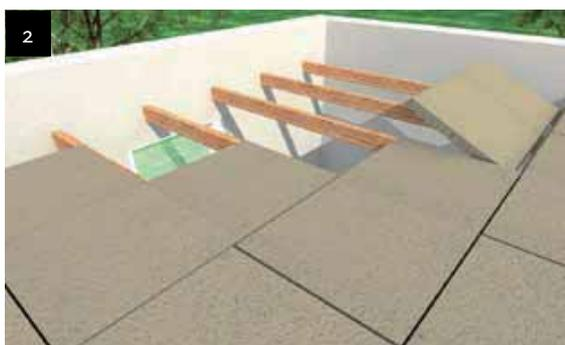
Poser les panneaux jointivement et perpendiculairement sur les poutres. Pendant les travaux, poser des planches sur les panneaux, surtout sur les zones de passage et de stockage.
