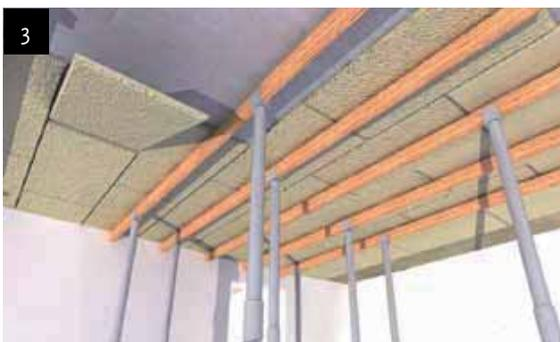
Placer les panneaux au bon endroit directement après application de la colle, étauçonner les panneaux. Uniquement pour application horizontale (plafond).
